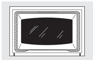
Le joint présente un jeu à la partie inférieure pour permettre une circulation d'air adéquat. Ne frottez pas ou ne nettoyez pas le joint de la porte—il présente une résistance extrêmement faible à l'abrasion.
