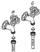
5. Branchez les extrémités du tuyau d'entrée aux robinets d'eau CHAUDE et FROIDE, en serrant légèrement à la main, puis en serrant encore 2/3 de tour avec des pinces. Ouvrez l'eau et vérifiez qu'il n'y ait pas de fuite.
