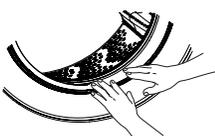
Tout en maintenant le joint en position basse, inspectez-en l'intérieur en tirant vers le bas avec les doigts.
